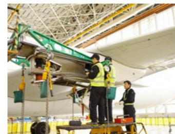
东航 C919 全球首架交付机首次换发工作圆满完成，填补了国产大飞机在民航维修能力的一项空白。
