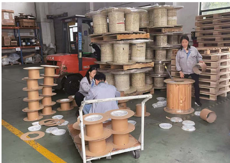
圖16：線盤翻新進行中，延長線盤壽命，減少廢棄物
